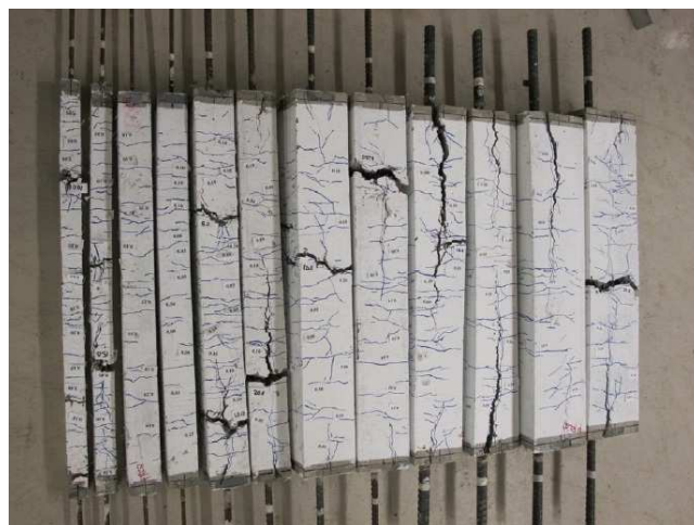
A.3 pav. FRC2 ( V_f = 1,0 \% , l_f/d_f = 79 ) betono mišinio išilginiu armatūros styryu armuotos supleišėjusios prizmės (Deluce 2011)
