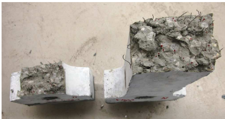
2.5 pav. Fibrų kiekis, pasiskirstymas ir orientacija pagrindiniame atsivėrusiame plyšyje (Deluce 2011)
