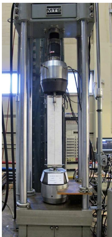
3.2 pav. Prizmių su išilginiu armatūros strypu tempimo bandymas (Deluce 2011)
