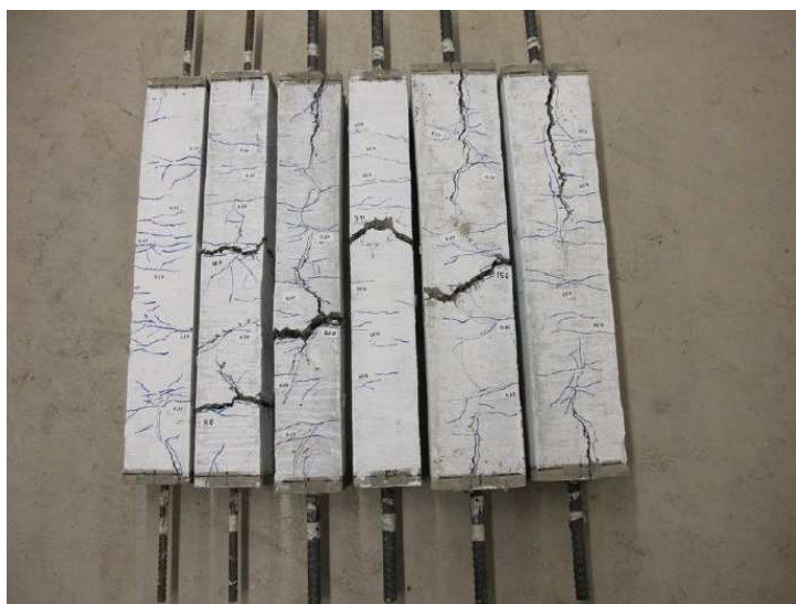
A.5 pav. FRC4 ( V_f = 1,5 \% , l/d_f = 55 ) betono mišinio išilginiu armatūros styriu armuotos supleišėjusios prizmės (Deluce 2011)
