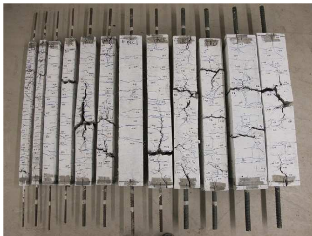
A.2 pav. FRC1 ( V_f = 0,5 \% , l_f/d_f = 79 ) betono mišinio išilginiu armatūros styryu armuotos supleišėjusios prizmės (Deluce 2011)
