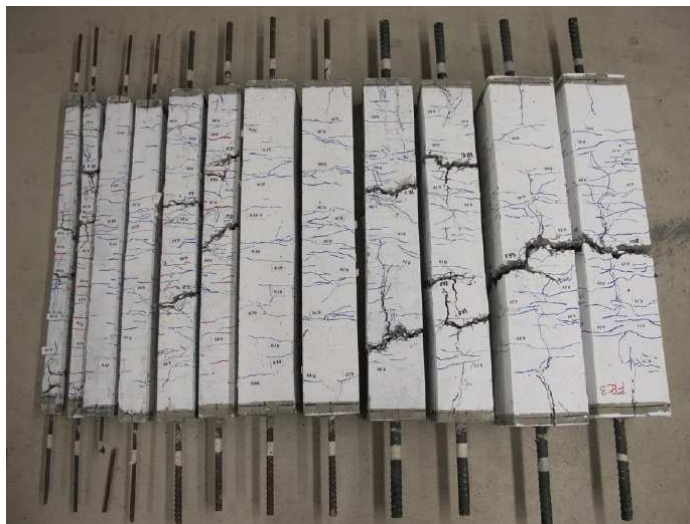
A.4 pav. FRC3 ( V_f = 1,5 \% , l/d_f = 79 ) betono mišinio išilginiu armatūros styriu armuotos supleišėjusios prizmės (Deluce 2011)
