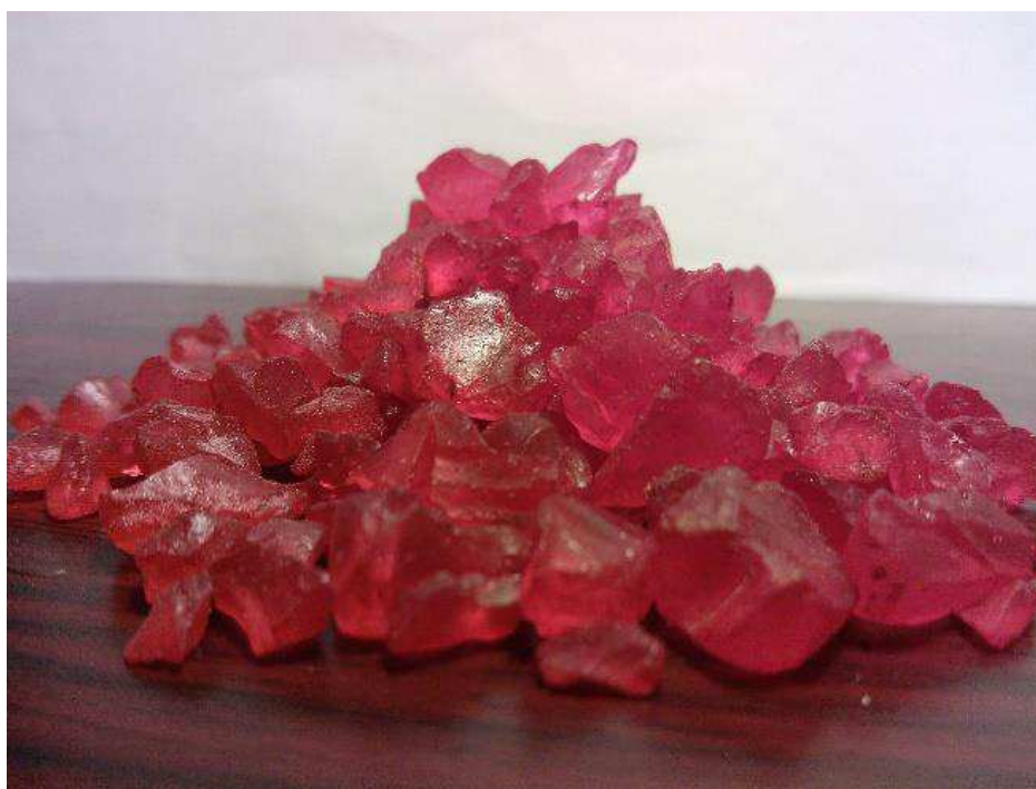
3.11 pav. Filtro įkrova – granuliuotas stiklas
