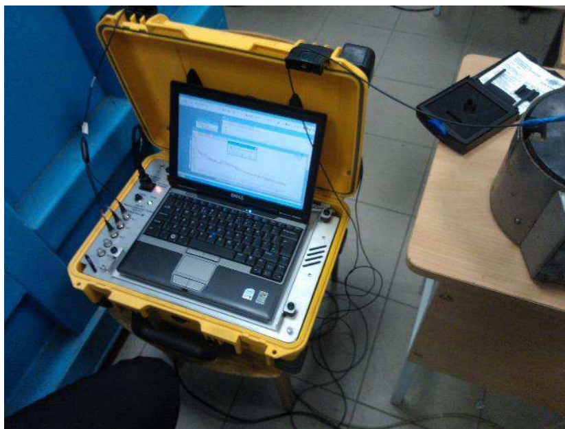
3.9 pav. Virpesių matavimo sistema „Type 9727“ – mašinų diagnostikos įrankių dėžė
