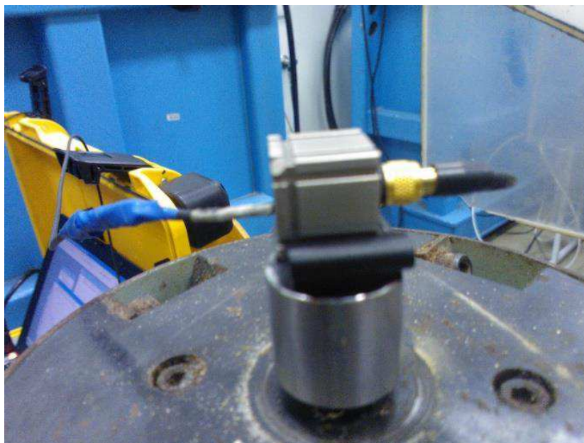
3.9 pav. Virpesių matavimo sistema „Type 9727“ – akselerometras
