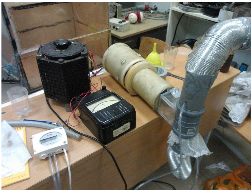
3.3 pav. Tyrimų standas su dviejų krypčių vibratoriumi
