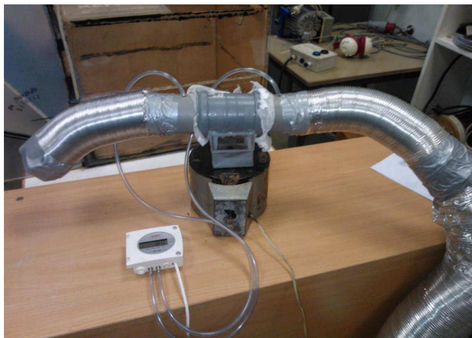
3.2 pav. Tyrimų stendas su vienos krypties vibratoriumi
