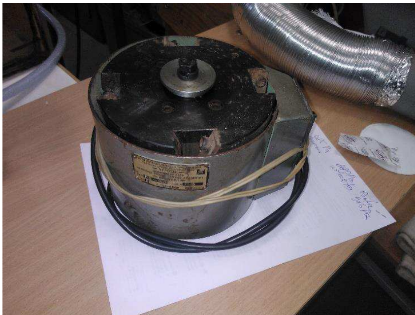
3.5 pav. Tyrime naudotas elektromagnetinis vienkryptis vibratorius
