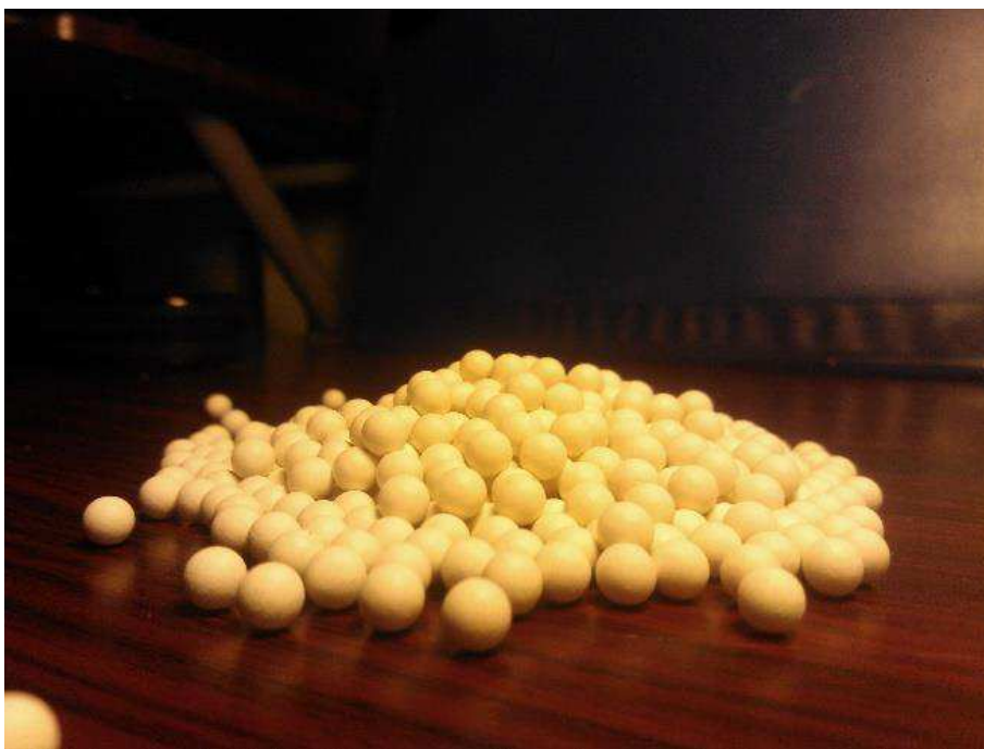
3.10 pav. Filtro įkrova – keraminiai rutuliukai
