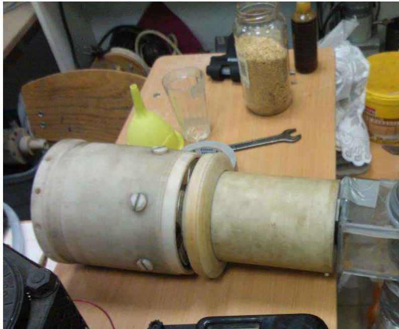
3.6 pav. Tyrime naudotas elektromagnetinis dviejų krypčių vibratorius
