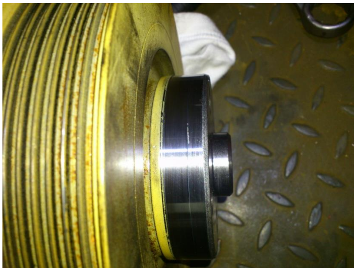
31 pav. PG pavaros skriemulio susidėvėjimo vietos
