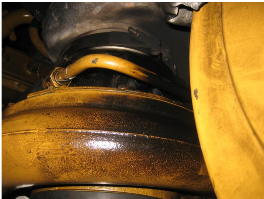
30 pav. Naudotų dujų prasiskverbimo vietos turbokompresoriaus srityje
