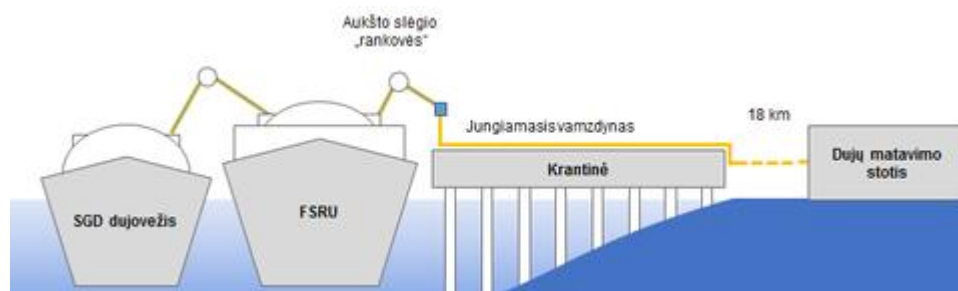
5 pav. SGDT sudedamųjų įrenginių schema [6]
