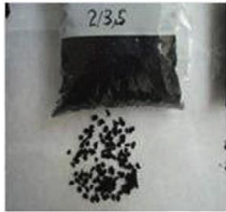
1.22 pav. Perdirbtos gumos drenažas žaliajam stogui (Rincon et al. 2014)
