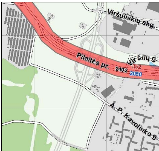
1.6 pav. Rytinės transporto srautų kartogramos ties Pilaitės pr. ir L. Asanavičiūtės g. (sudaryta autoriaus)
