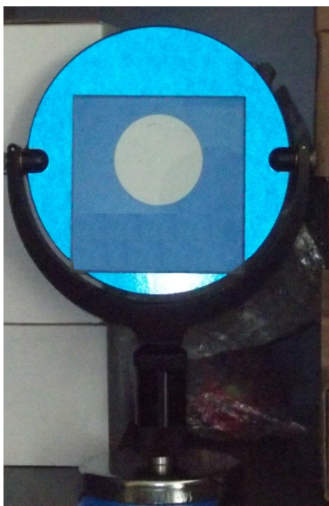
38 pav. skenuojamas objekto paviršius uždengtas stiklu
