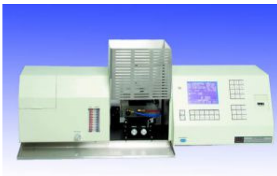
2.5 pav. Atominės absorbcijos spektrometras (AAS) Buck Scientific 210 VGP
