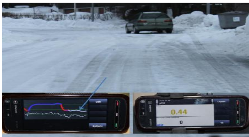
2.22 pav. Kairėje RSM 411 vartotojo sąsajos rodomas sukibimo koeficiento kitimas (0,5), dešinėje – \mu Tec išmatuotas sukibimo koeficientas (0,44). Rodyklė vaizduoja nustatytą dangos būklę (sniegą) (Skrodenis ir kiti 2012)
