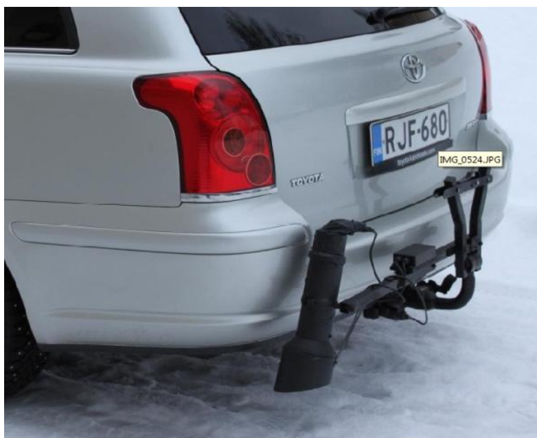
2.21 pav. Mobilus optinis kelio dangos būklės matavimo prietaisas RCM 411, pritvirtintas prie automobilio kablų (Miškinis 2013)
