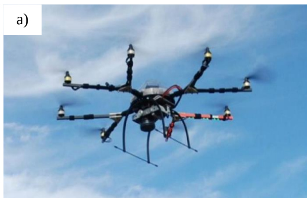
3.5 pav. Vietovės fotografavimui naudoti bepiločiai orlaiviai: a) vertikalios kilimo ir leidimosi (VTOL) klasės Octocopter'is; b) mažųjų orlaivių (MAV) klasei priskiriamas SwingletCam modelis
