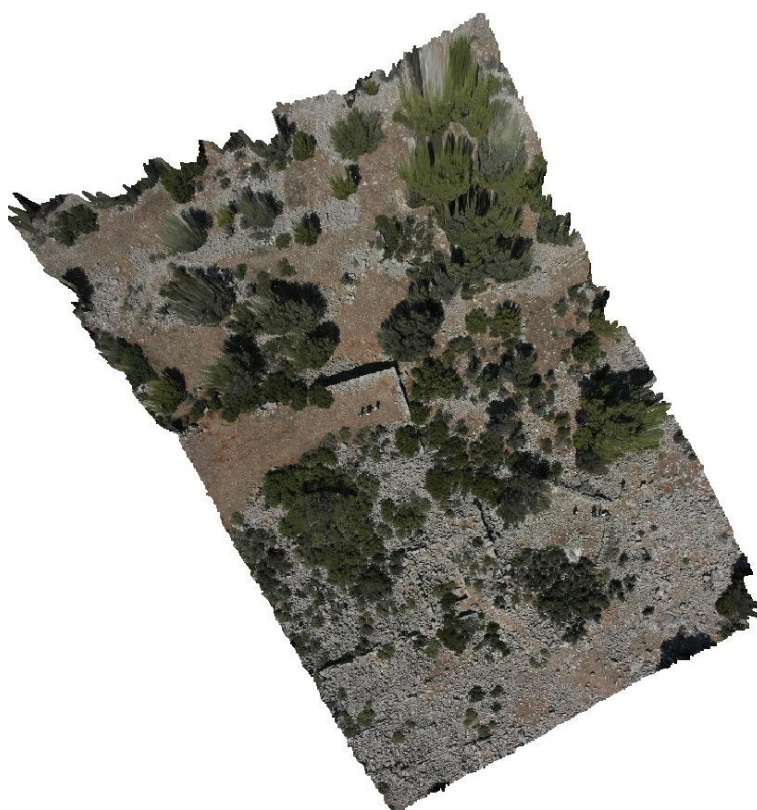
3.7 pav. Ortografinė nuotrauka sudaryta pagal Octocopter gautus fotografinius vaizdus su ImageMaster kompiuterine sistema
