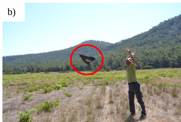
3.5 pav. Vietovės fotografavimui naudoti bepiločiai orlaiviai: a) vertikalios kilimo ir leidimosi (VTOL) klasės Octocopter'is; b) mažųjų orlaivių (MAV) klasei priskiriamas SwingletCam modelis
