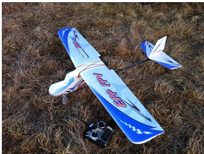
4.3 pav. Aerofotografavimui naudota skraidymo priemonė su skaitmeniniu imtuvu
