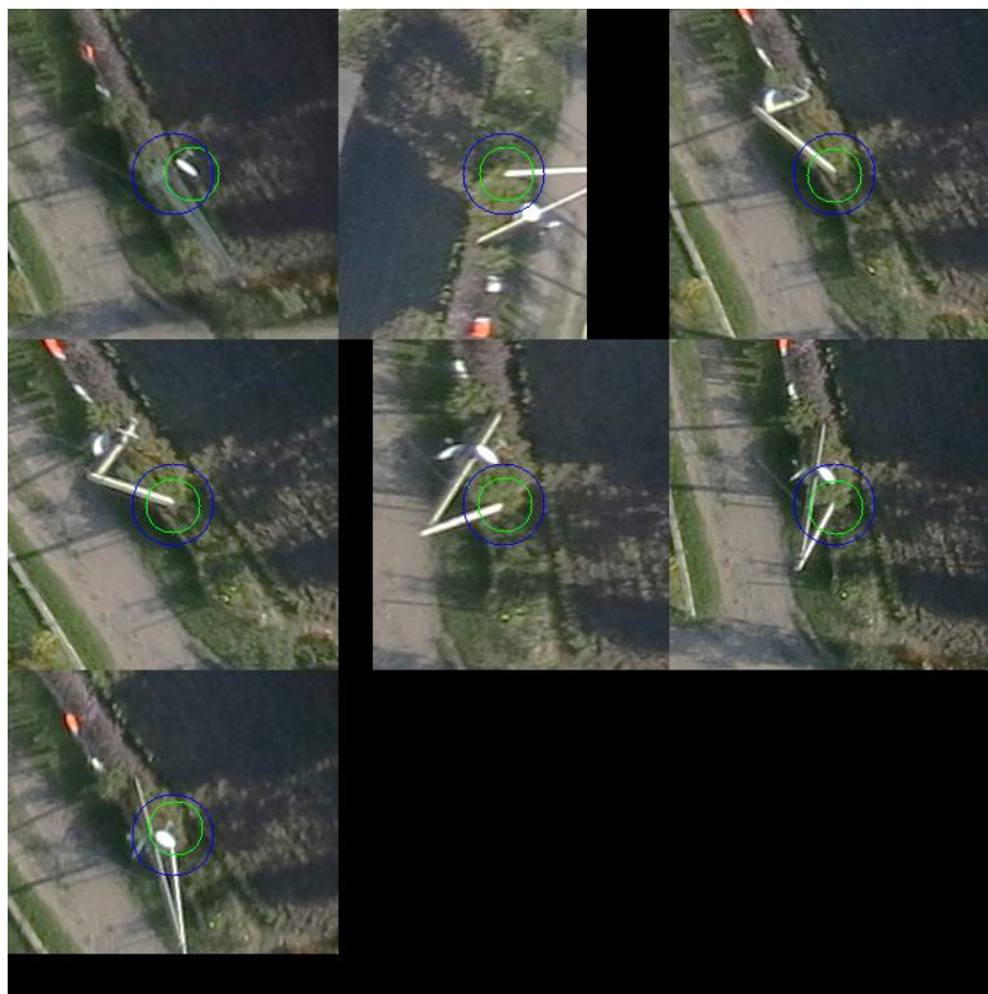
4.34 pav. Atramos taško indentifikavimas septyniose aerofotonuotrukose. Mėlynas apskritimas žymi matavimo plotą, žalias – 3D taško projekciją į vaizdus. Matavimai atlikti leistinos paklaidos ribose, kai žalias apskritimas yra mėlynojo viduje
