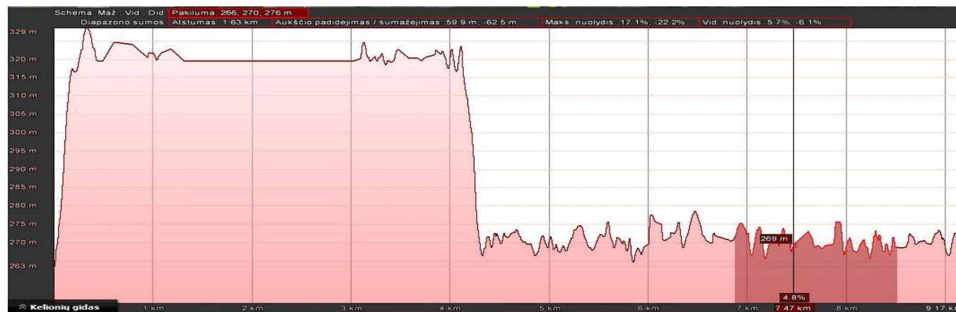
2 pav. Aukščių profilio informacija iš poligono, kuriame skrydžio metu gautos aerofotonuotraukos buvo fotogrametriškai apdorotos (tamsiai raudona)
