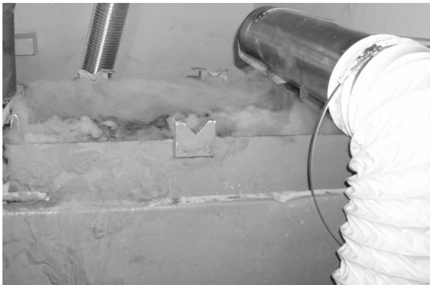
3.9 pav. Garavimo vizualizacija siurbtuvui neveikiant
