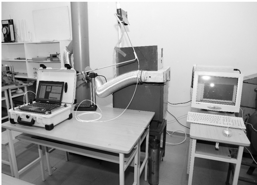
3.2 pav. Šoninio siurbtuvo, aktyvinamo aeroakustiniu srautu, stendo nuotrauka
