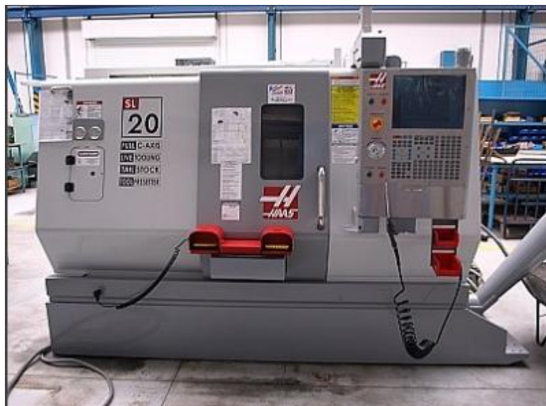
3.4 pav. CNC Tekimo staklės HAAS SL-20
