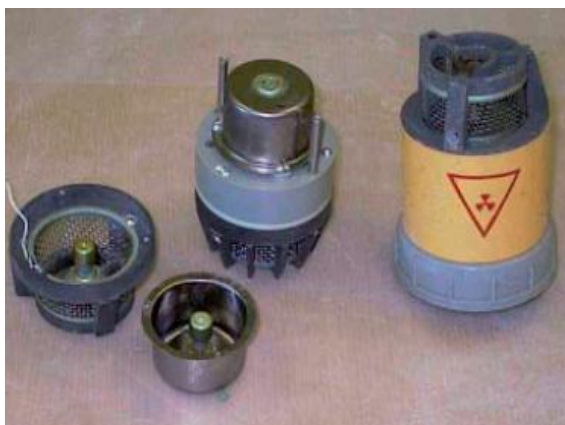
2.1 pav. Plutonio ^{239}\text{Pu} dūmų jutiklis
