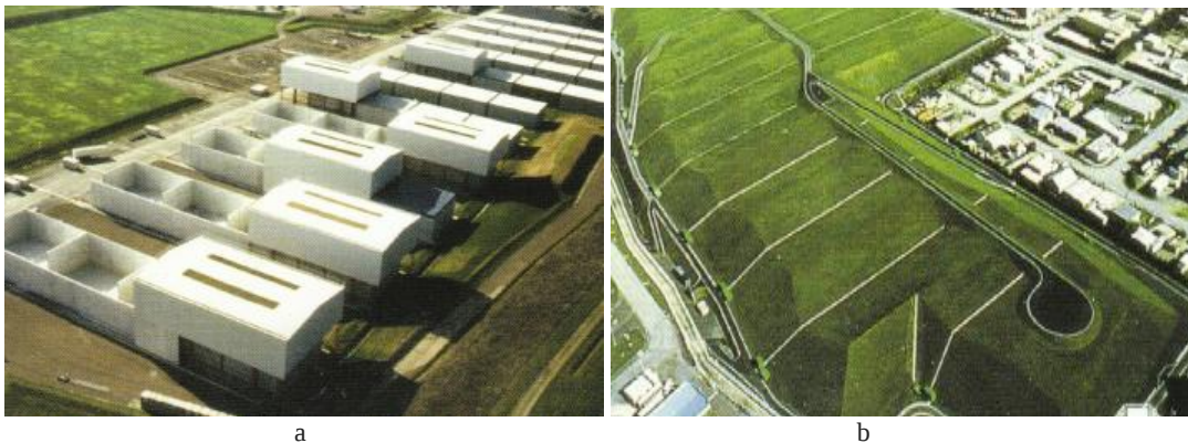
1.28 pav. Paviršinis kapinynas: a – mažo ir vidutinio aktyvumo Prancūzijos l' Aube; b – neeksploatuojamas la Mansche
