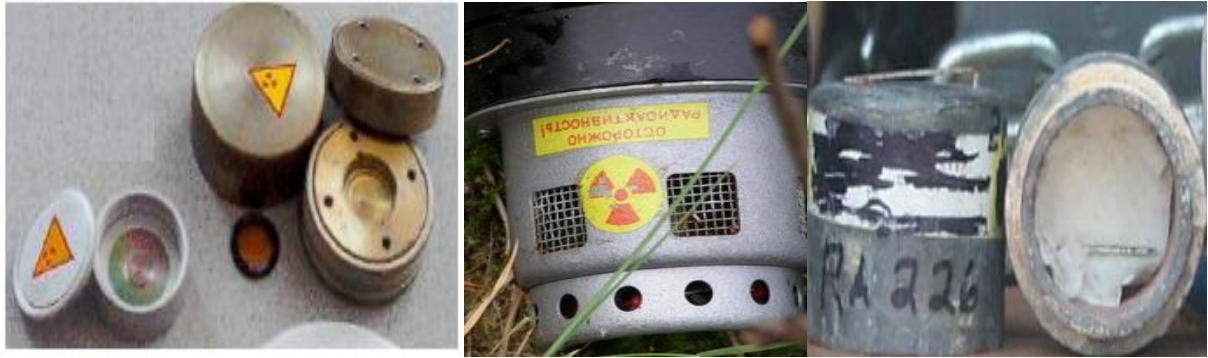
1.2 pav. Jonizuojančiosios spinduliuotės šaltiniai su ^{239}\text{Pu} ir ^{226}\text{Ra} radionuklidais
