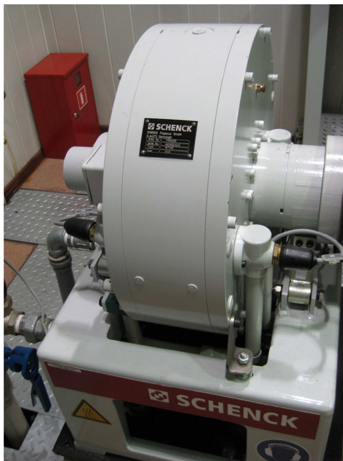
14 pav. Variklio apkrovos stendas SCHENCK WT190
