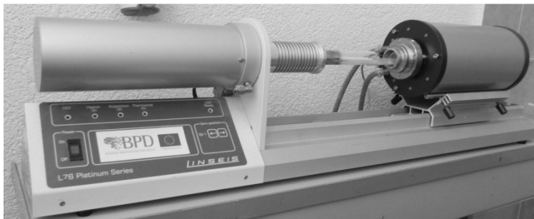
2.13 pav. Dilatometras „LINSEIS L76“ Fig. 2.13. Dilatometer “LINSEIS L76”
