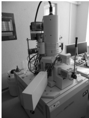
2.9 pav. Skenuojantis elektroninis mikroskopas „JEOL JSM-7600F“
