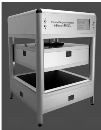
2.15 pav. Kompiuterizuota įranga „λ-Meter EP 500“ AAB šilumos laidumo koeficientui nustatyti
