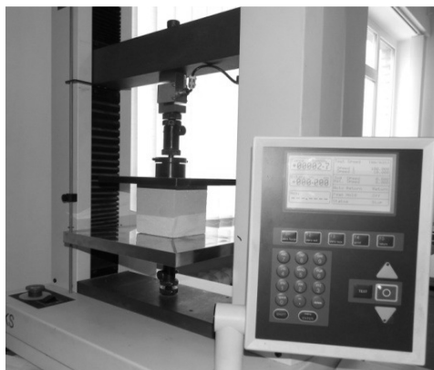
2.12. pav. Kompiuterizuota įranga „Haunsfield-H10KS“ AAB gniuždymo stipriui nustatyti
