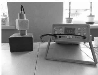
2.11. pav. UIG matavimo prietaisas „UK-14P“
