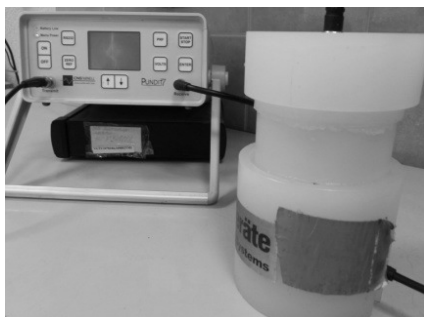
2.7. pav. Formavimo mišinių UIG matavimo prietaisas „Pundit 7“
