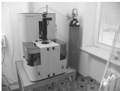
2.10 pav. Porozimetras „PoreMaster 33“
