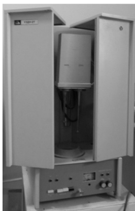
2.6 pav. Ultragarso smulkių dalelių sklaidiklis „UZDN-21“
