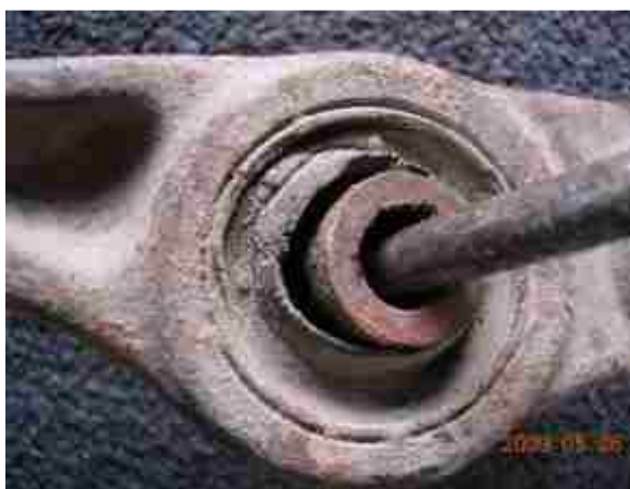
1.11 pav. Tilto riebokšlio gedimas
