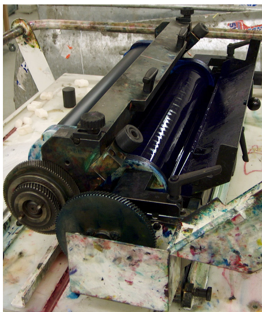
1.6 pav. Aniloksinio ir duktorinio velenų krumpliaratinė sankaba
