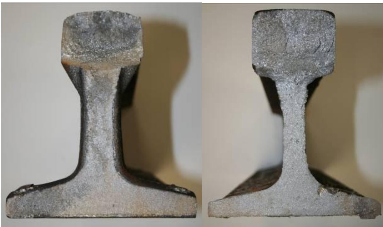
4.3 pav. BHHD 2,5 min. Jokių matomų defektų. Suardymo apkrova 1289 kN, įlinkis 10 mm
