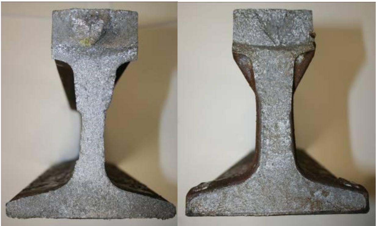
4.2 pav. BH 5 min. Jokių matomų defektų. Suardymo apkrova 1517 kN, įlinkis 12 mm
