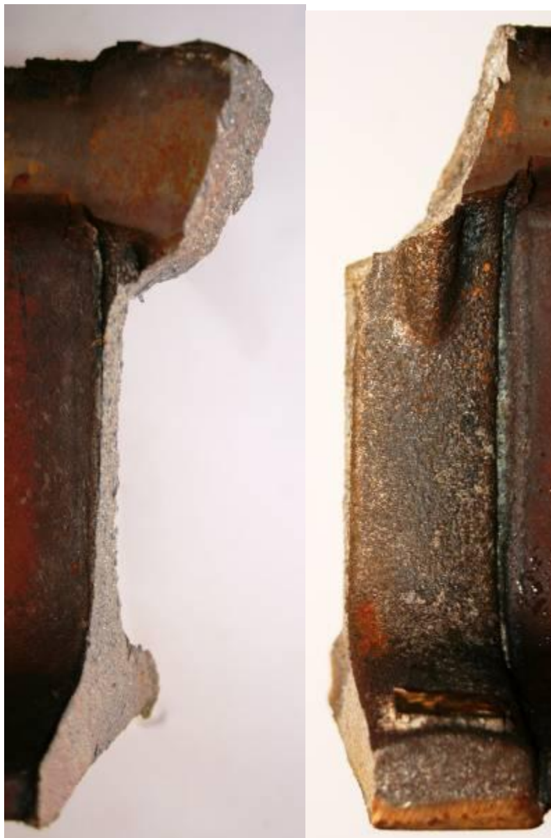
4.5 pav. Suvirintos termitiniu būdu, bėgio jungties lūžis
