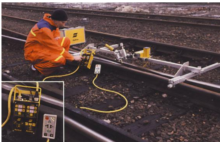
2.14 pav. „Railtrac BV“ – programuojamasis bėgių apvirinimo automatas
