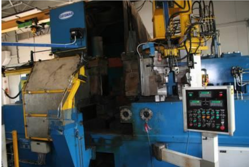
2.8 pav. Kontaktinio sandūrinio suvirinimo stacionari mašina
