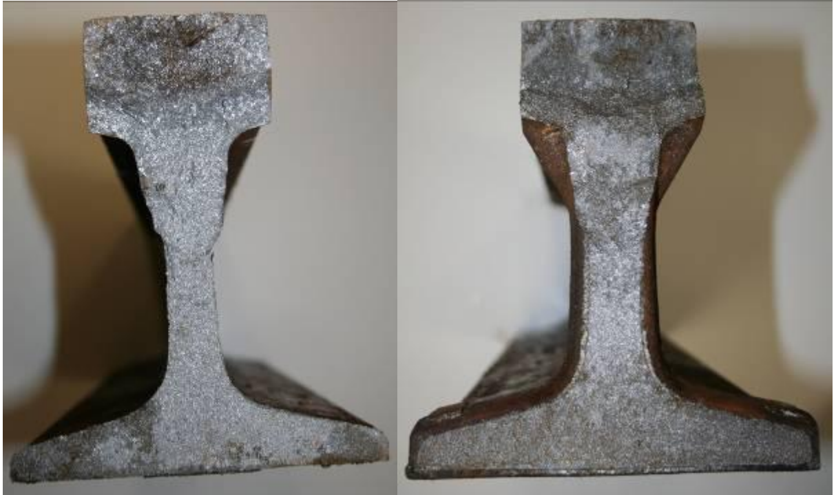
4.1 pav. BHHD 5 min. Jokių matomų defektų. Suardymo apkrova 1332 kN, įlinkis 9 mm
