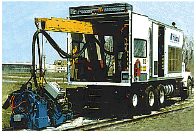
2.9 pav. Kontaktinio sandūrinio suvirinimo mobili mašina
