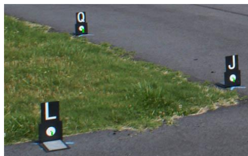
3. 9 pav. Fotogrametrinių taikinių išdėstymas tacheometru išmatuotose vietose (Accuracy Performance 2008)
