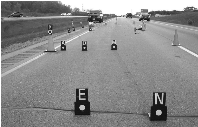
3. 3 pav. Atraminiai taškai – taikiniai ( iWitness & iWitnessPRO 2013)
