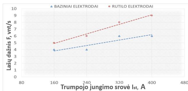
13 pav. Išlydytų lašelių nukritimas į suvirinimo vonelę per vieną sekundę, virinant glaistytaisiais elektrodais, kurių skersmuo 4,0 mm Fig.13 Molten droplets drop into the weld pool in one second welding electrodes - Ø 4.0 mm
