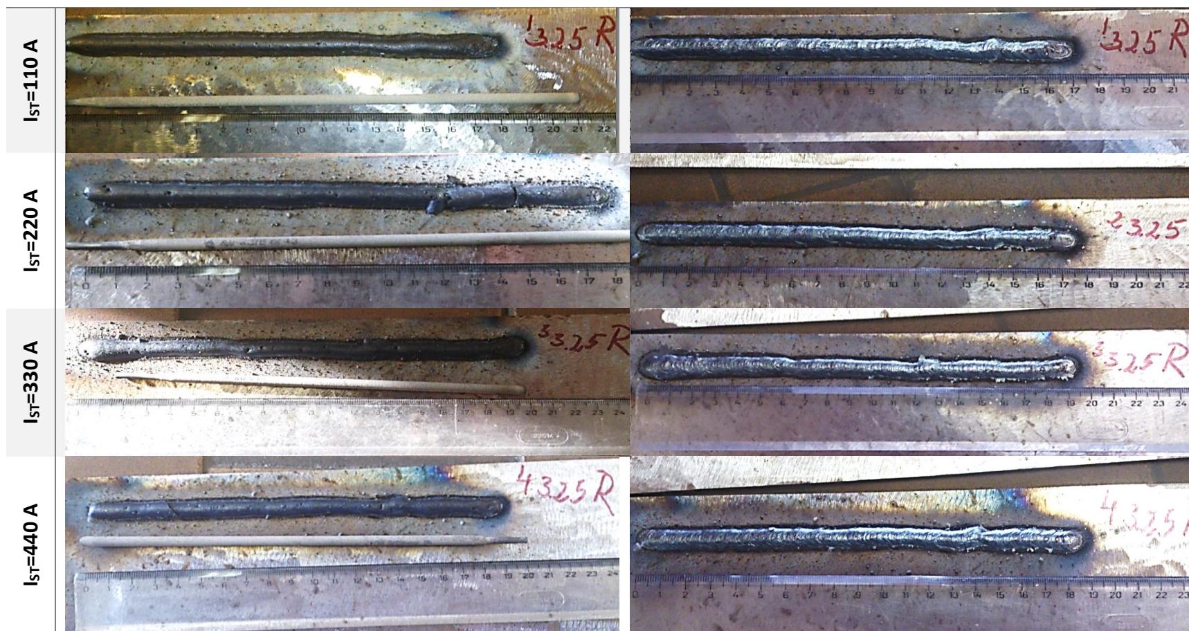
3 Pav. Bandinių apvirinimas ant mažanglio S235J2 plieno, kai I_{apv} = 110\text{ A} , U_1 = 24\text{ V} , plokštelės storis 6 mm, naudojami d_{el} = 3,25\text{ mm} glaistytieji elektrodai AV-23
