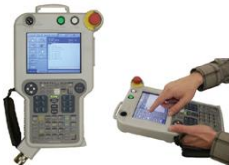
20 pav. Roboto „Motoman SSF2000“ valdymo bloko NX100 nešiojamas valdymo pultas
