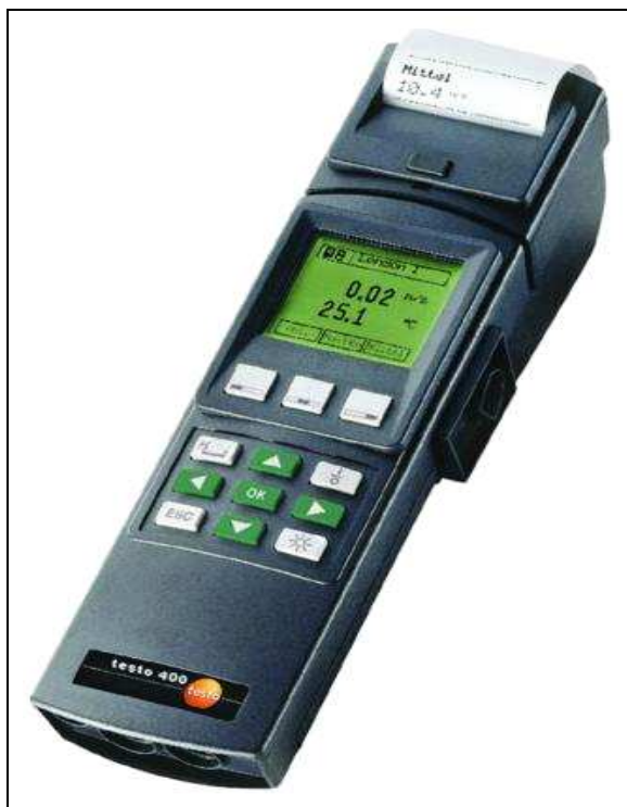
2.5 pav. Multifunkcinis fizinių parametrų analizatorius „Testo 400“ .
