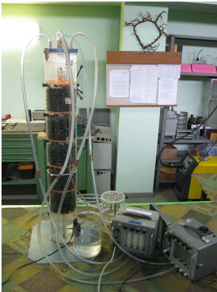
3.3 pav. Biofiltras su polimerine įkrova (Autoriaus nuotrauka)
