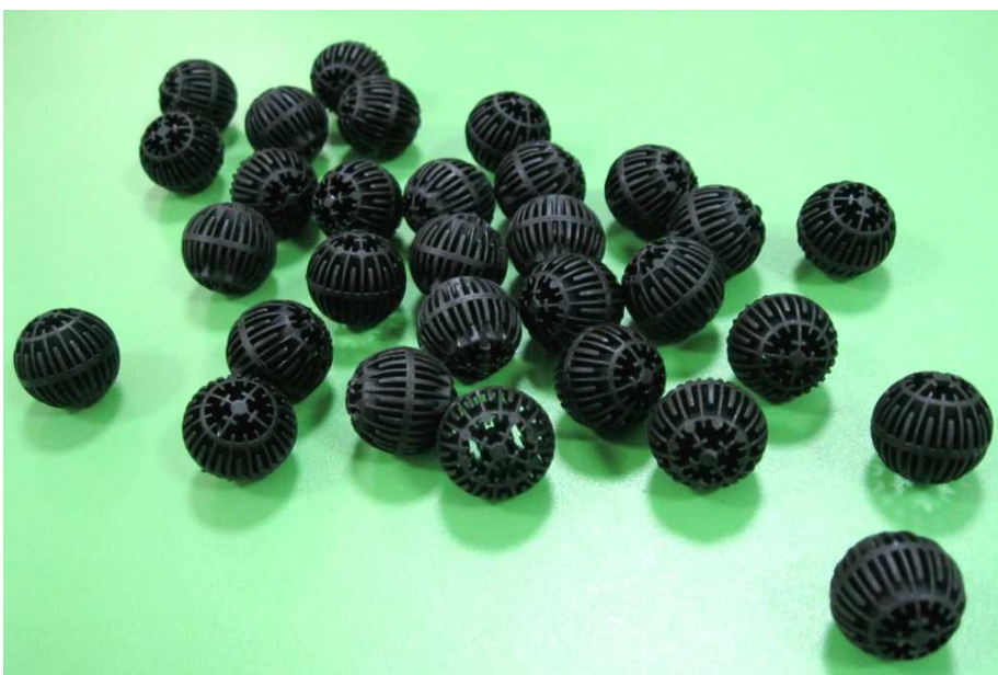
3.2 pav. Dirbtinės kilmės biofilto įkrova – didelį filtruojančio paviršiaus plotą turintys polimeriniai rutuliukai (Autoriaus nuotrauka)
