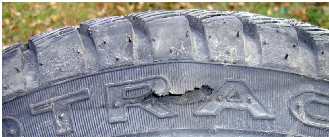
14 pav. Atsiklijavęs restauruotos padangos protektoriaus sluoksnis
