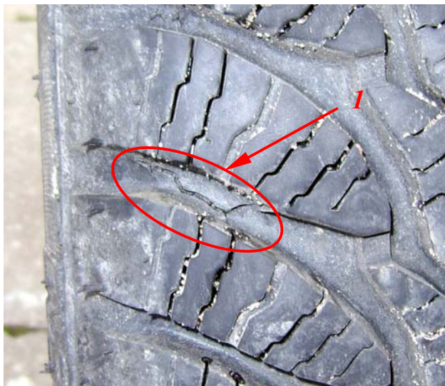
13 pav. Restauruota padanga. 1 – įtrūkęs gumos sluoksnis
