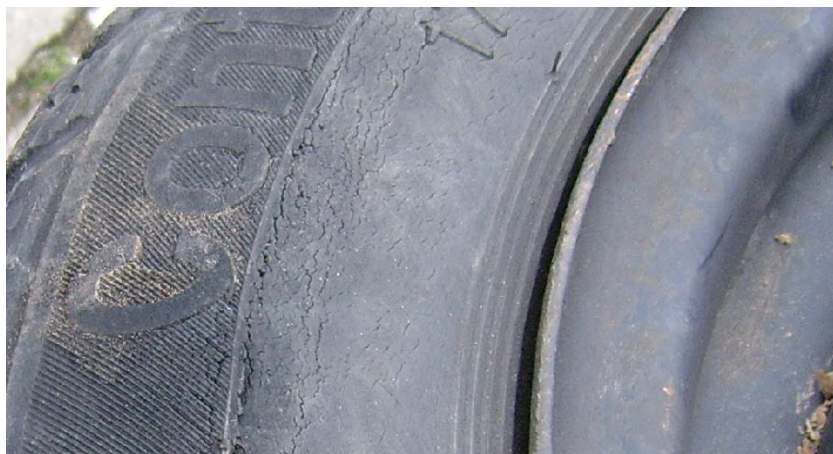
11 pav. Sutrūkinėjusi padangos guma
