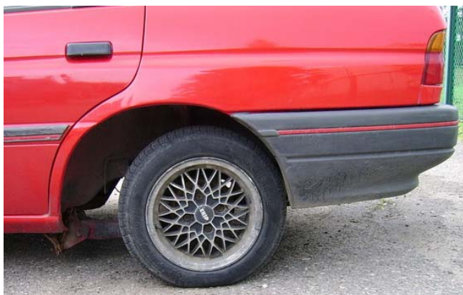
30 pav. Dalinai atitrūkusi automobilio „Ford Escort“ užpakalinė ratų ašis
