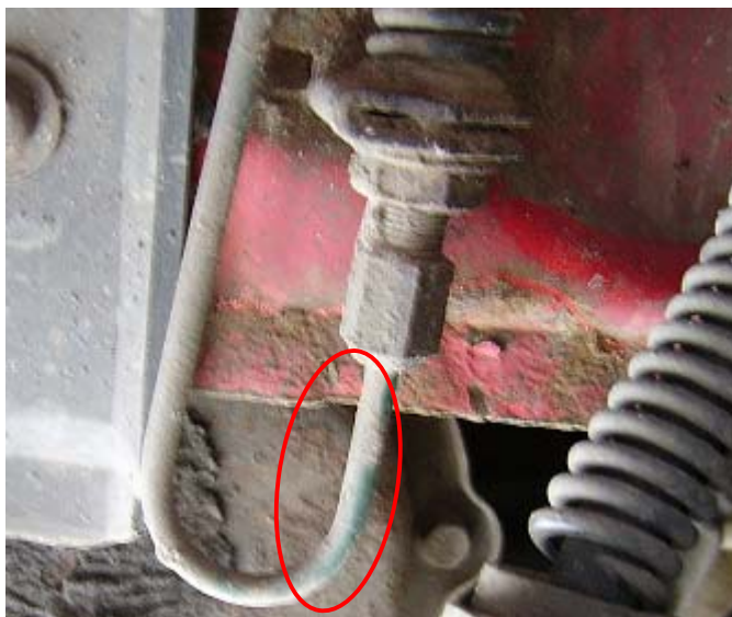
35 pav. Stabdžių vamzdelio vieta, į kurią trynėsi žarnelė
