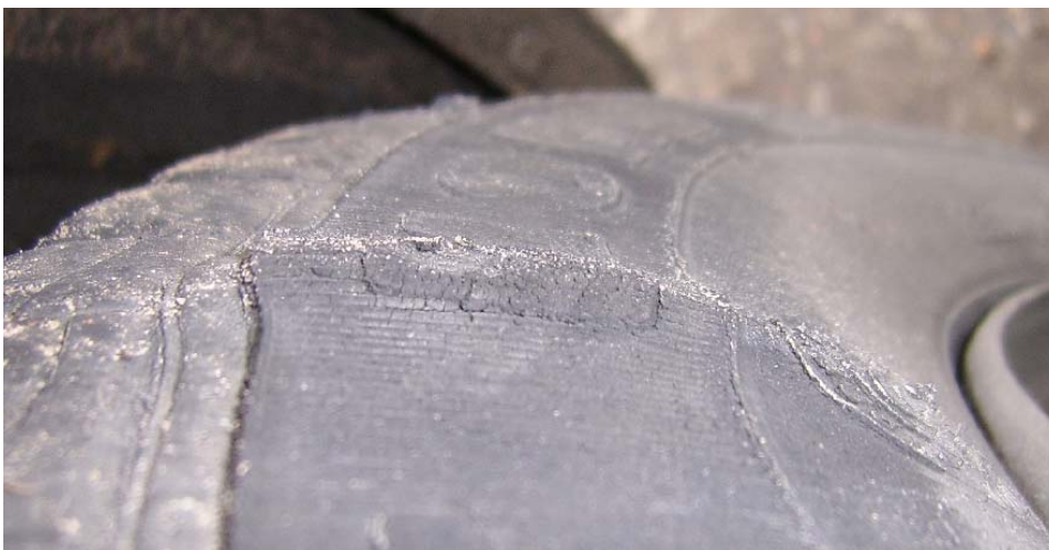
15 pav. Šoniniame padangos paviršiuje atsiradęs gumbas
