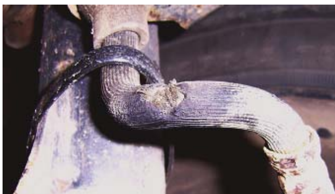
34 pav. Sudilęs stabdžių skysčio žarnelės išorinis paviršius
