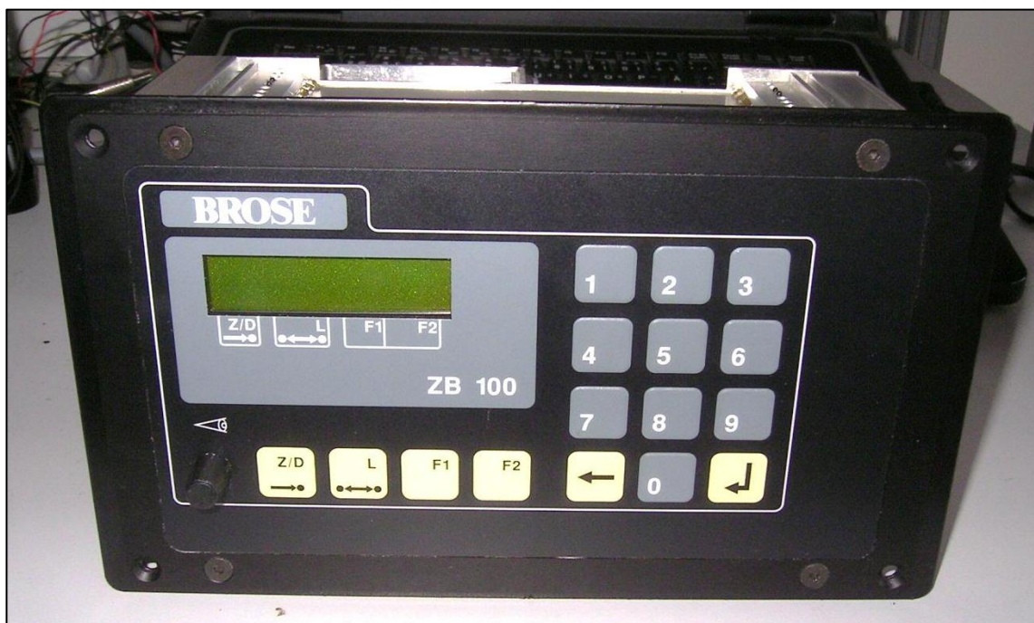
2.13 pav. „Brose“ informacinės sistemos pagrindinis valdiklis „ZB 100“
