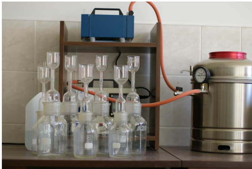
3.4 pav. Piknometrai naudojami asfalto mišinio didžiausiam tankiui nustatyti
