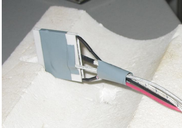
3.1.1.2. pav. Peltje elementas su temperatūros jutikliais pritvirtintas prie kitos ir darbinės pusių
