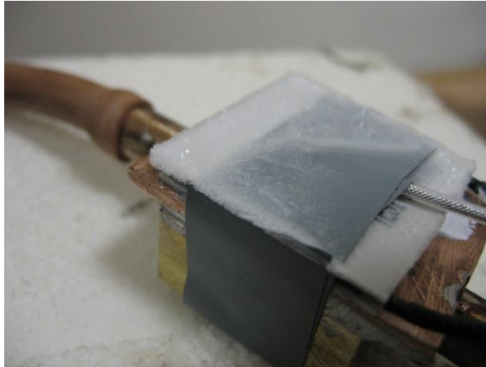
3.1.4.5. pav. Apšalęs Peltje elementas su šilumos nuvedimu pasiekęs -4,3^{\circ}\text{C}
