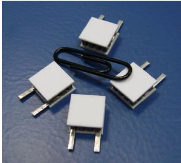
2.1.3.2. pav. Termoelektriniai radioelektronikos moduliai [5]
