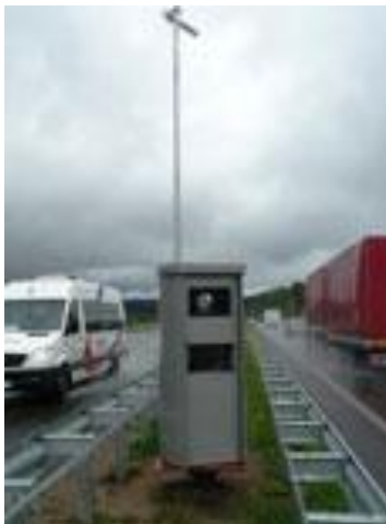
2.3 pav. Stacionarus „PoliScan Speed“ markės greičio matuoklis
