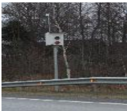
4.15 pav. Stacionarus „MultaRadar S580“ markės greičio matuoklis
