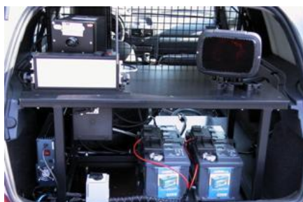
4.16 pav. Mobilus „MultaRadar C“ markės greičio matuoklis
