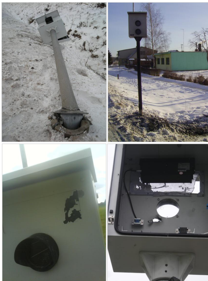
5.2 pav. Neplanuotų vandalizmo atvejų metu apgadintų greičio matuoklių pavyzdžiai
