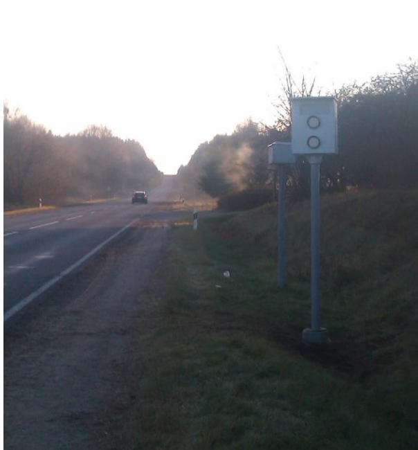
3.6 pav. A4 107,83 km įrengtas imitacinis greičio matuoklis šalia stacionaraus eismo intensyvumo apskaitos posto
