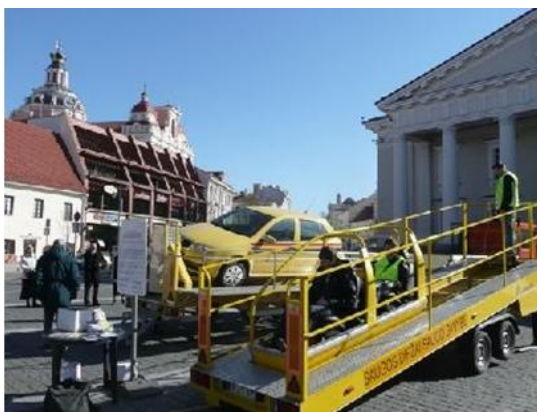
2.7 pav. Saugos diržų patvarumą demonstruojantis automobilis ir stendas imituojantis susidūrimą su kliūtimi
