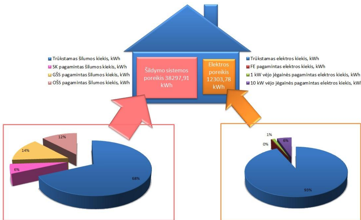
29 pav. Vasario mėnesio pastatui energijos balansas
