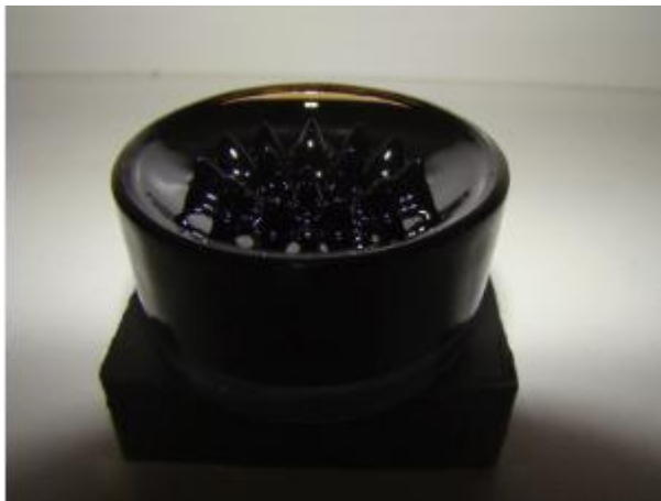
19 pav. Feromagnetinis skystis, kuris yra naudojamas šiame tyrime – EFH1
