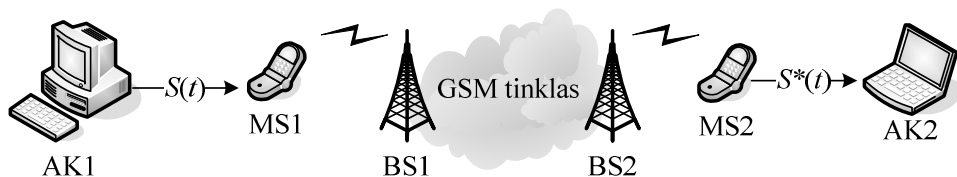
3.1 pav. Balso paketų srautų duomenų rinkimo schema
