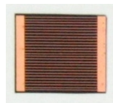
2 pav. Eksperimentams naudotas silicio saulės elementas ( 12 \times 13 \text{ mm}^2 ): apatinis jo paviršius padengtas 3 \mu\text{m} storio aliuminio sluoksniu, o viršutinis paviršius su 20 \mu\text{m} storio variniais elektrodais
