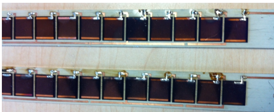
57 pav. Fotoelementų juostelės su prilituotais elementais (II jungtinio parabolinio koncentratoriaus testavimui)
