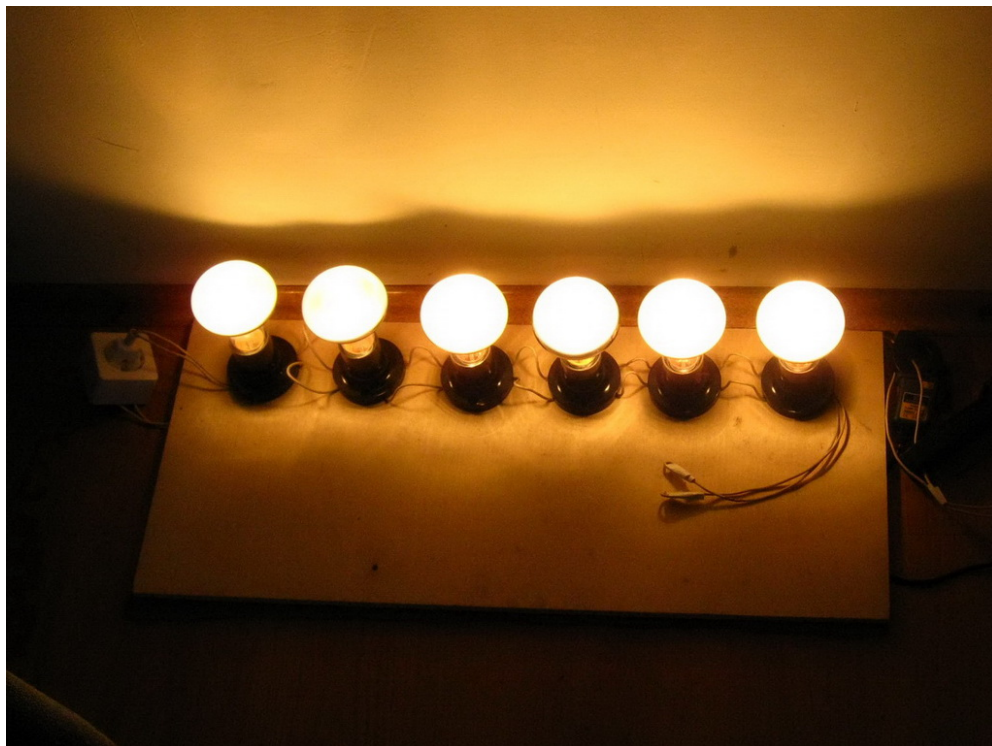
4.66 pav. Inverterio su išėjimo filtru apkrova, sudaryta iš šešių kaitrinių lempų
