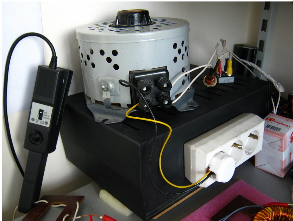
4.67 pav. Nuolatinės 320 V įtampos šaltinis su skiriamuoju ir autotransformatoriumi
