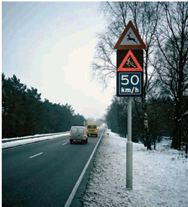
11 pav. Kelio ženklinimo ir pakelių sensorinės sistemos. Įspėjamasis ir nurodomasis kelio ženklai pradeda mirksėti, kai prie kelio priartėja elniai [1]
