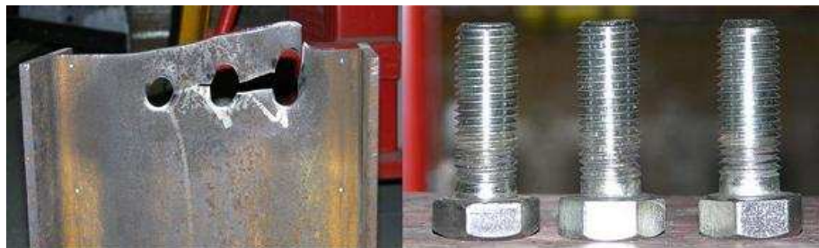
1.21 pav. Kirpimas per sijos sienelę, 20 °C
