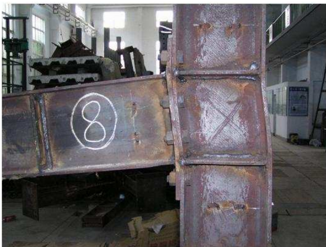
1.19 pav. Deformuotas sijos-kolonos sujungimas, viršuje su standumo briaunomis, apačioje be standumo briaunų
