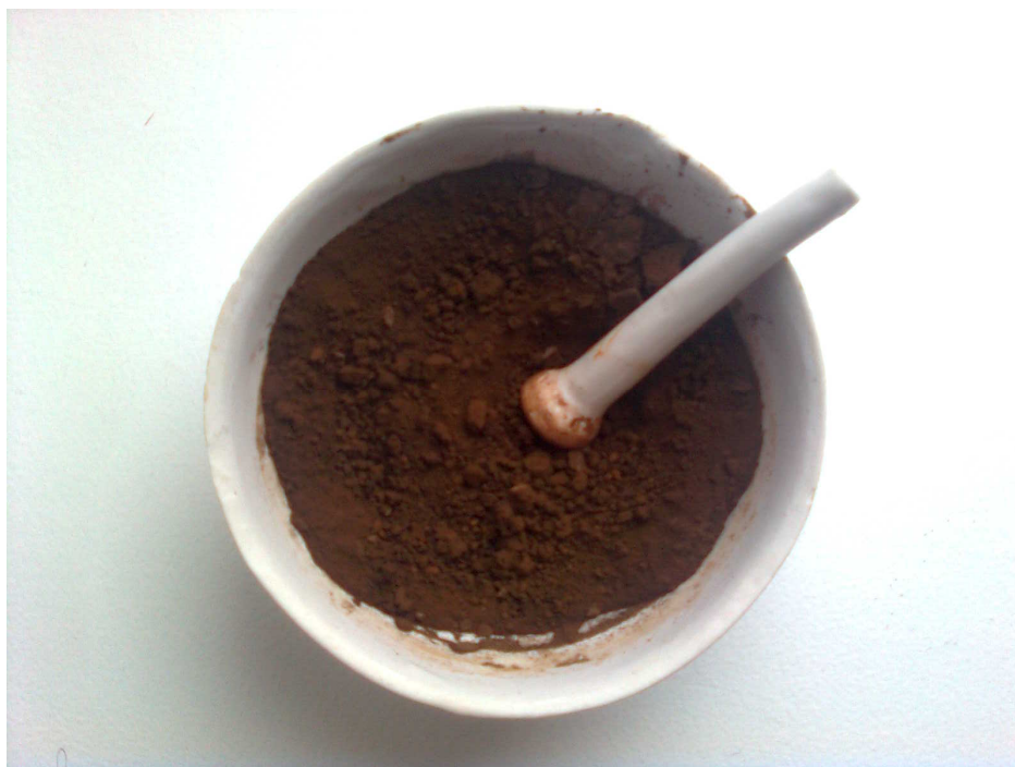
8 pav. Nuogulos trinamos grūstuvėliu porcelianinėje lėkštelėje.
