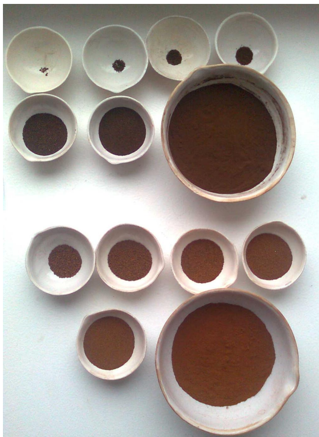
9 pav. Nuogulų dalelės, likusios ant kiekvieno sieto, supiltos į porcelianinius dubenėlius.
