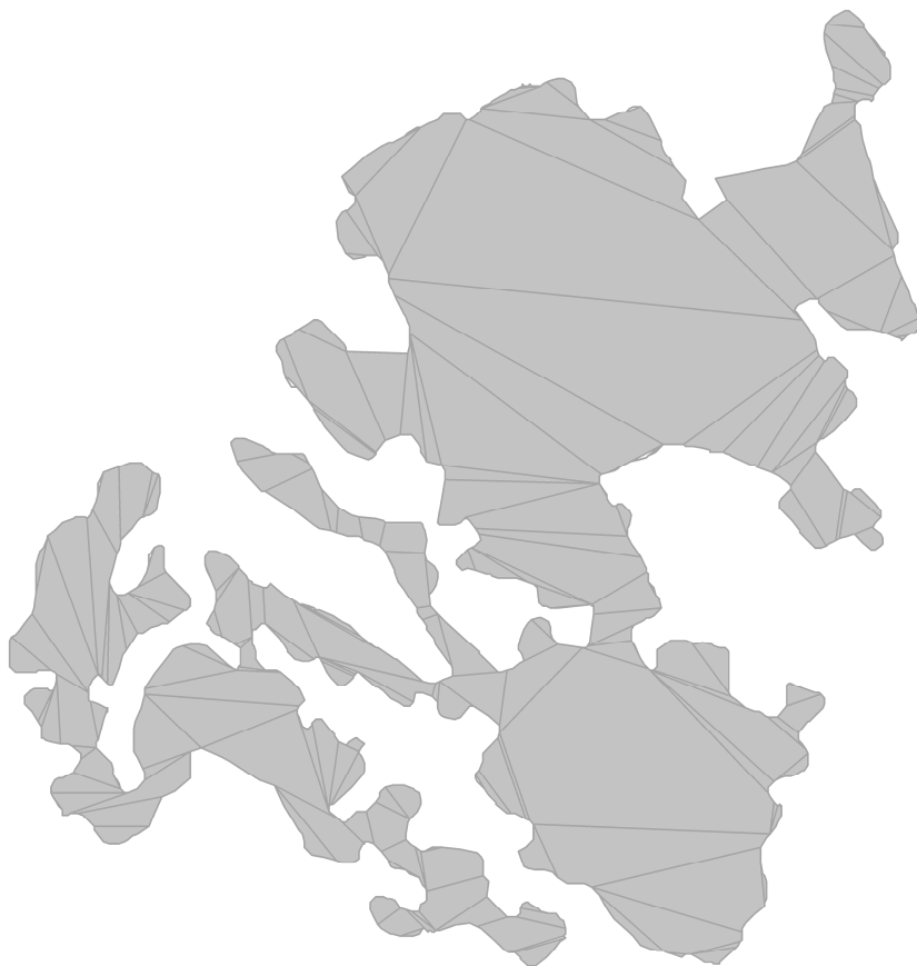
6 pav. Daugiakampio iš 1300 viršūnių padalijimas modifikuotu ACD algoritmu
