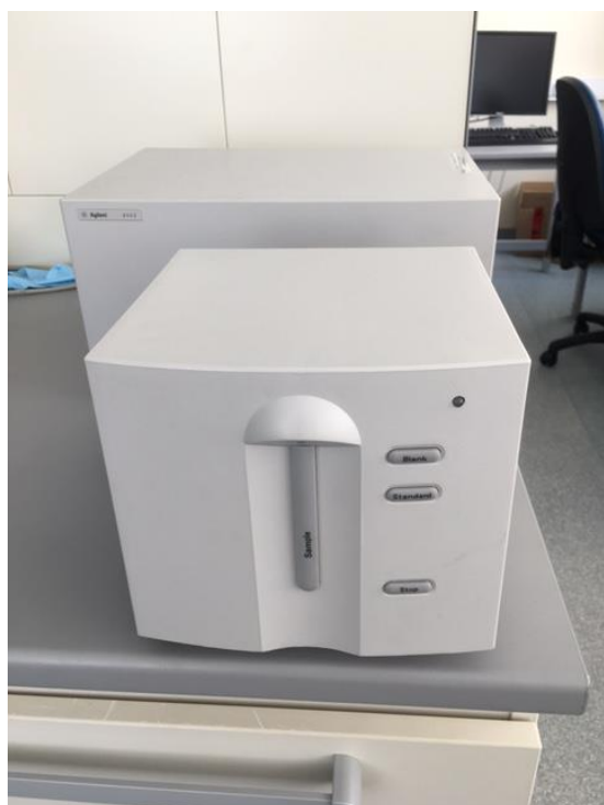
2 pav. Agilent 8453 spektrofotometras, naudotas tyrimui
