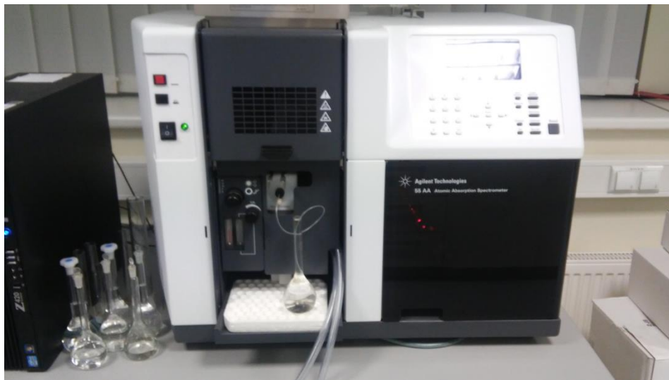
6 pav. Agilent 55B AA spektroskopas naudotas tyrimui
