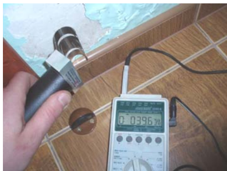
2.2 pav. Atitvarų drėgmės matavimas
