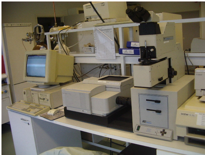
7.5 pav. ATI Matson Genesis Series RTIR spektroskopas bei periferinė įranga
