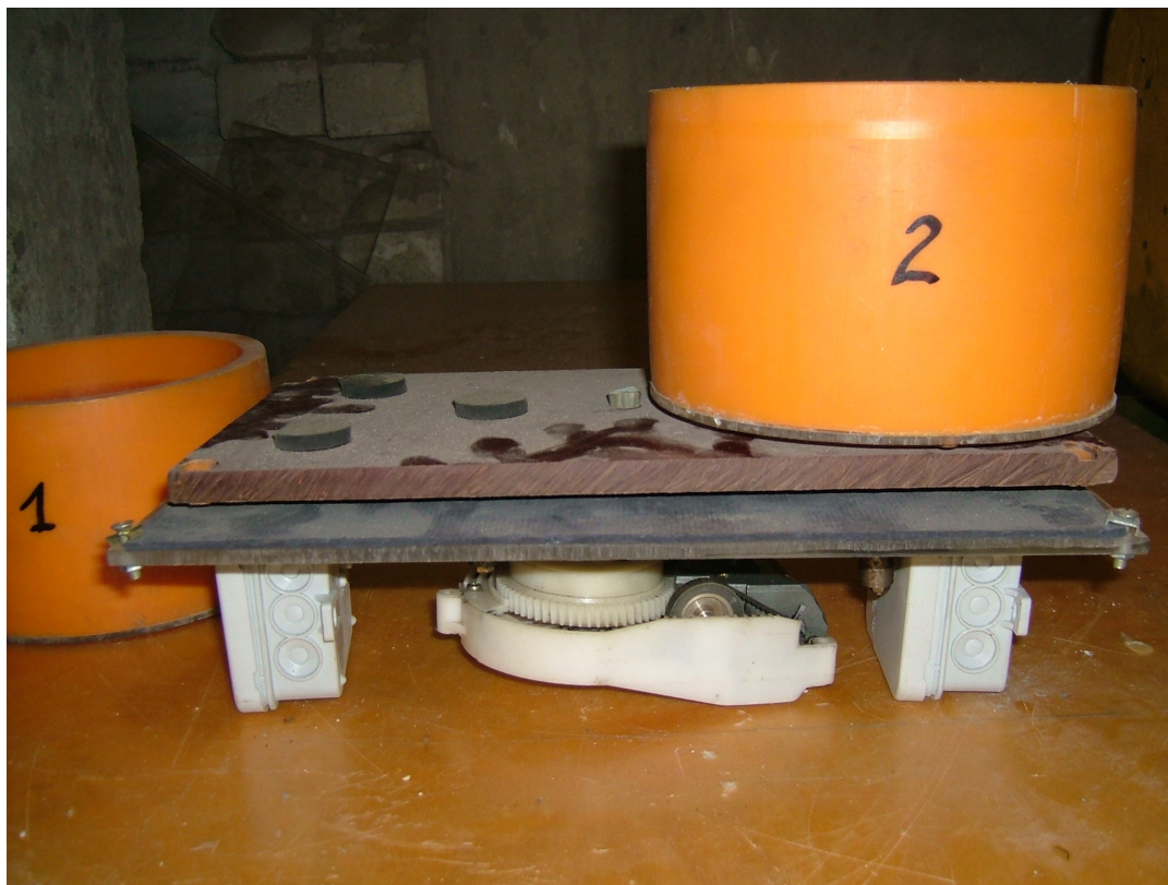
7.3 pav. Vibro stotelis pritaikytas sorbertų tyrimui dinaminėmis sąlygomis
