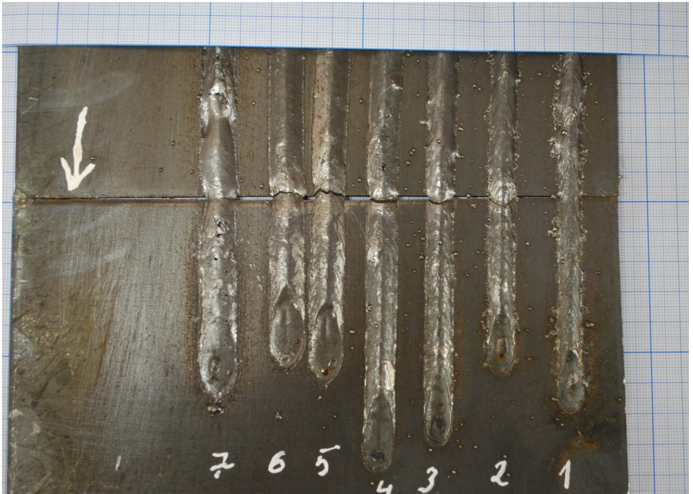
8.1 pav. Pirmojo bandinio siūlių bendras vaizdas. 1 siūlė – lanko ilgio reikšmė (-9); 2 siūlė – (-6); 3 siūlė – (-3); 4 siūlė – (0); 5 siūlė (3); 6 siūlė – (6); 7 siūlė – (9)
