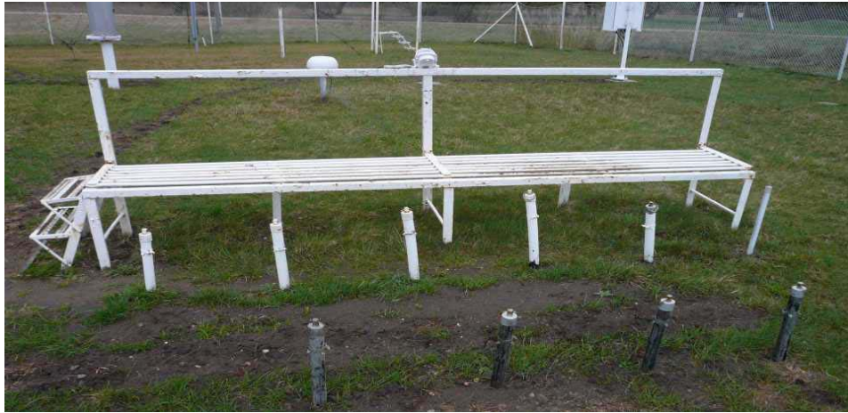
C.1 pav. Grunto termometrai bei pašalomatis (iš dešinės pusės paskutinis baltas vamzdelis)
