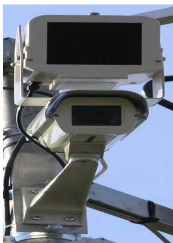
C.11 pav. KOSIS vaizdo kamera su IR apšvietimu
