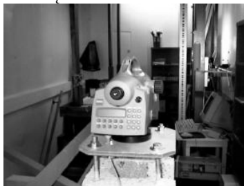
1.11 pav. Suomijos geodezijos instituto naudojama skaitmeninio nivelyro ir kodinės matuoklės kalibravimo sistema
