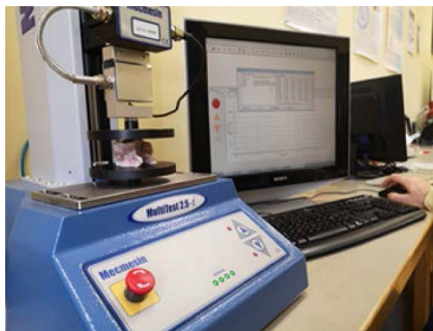
2.3 pav. Šuns juosmens stuburo slankstelio gniuždymas
