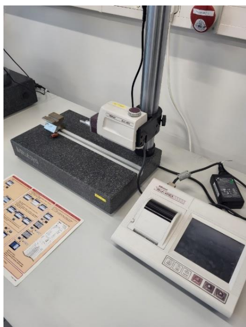
Fig. 4 Mitutoyo profilometer model SJ-410
