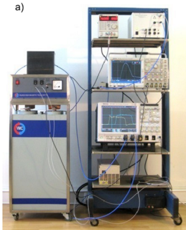
30 pav. Impulsinio magnetinio lauko įranga: impulsinio magnetinio lauko šaltinis su elektrinio impulso generatoriumi bei matavimo įranga.
