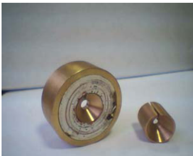
17 pav. Impulsinis transformatorius ir magnetinio srauto konsentratorius
