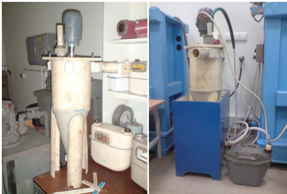
21 pav. Absorberio modelis (kairėje), tyrimo stendas (dešinėje)
