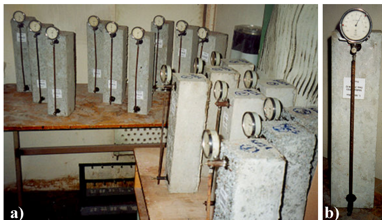
3.12 pav. Prizmių susitraukimo deformacijų matavimo eksperimentas: a – bendras vaizdas; b – prizmė su pritvirtintu laikrodinio tipo deformacijų matavimo prietaisu
