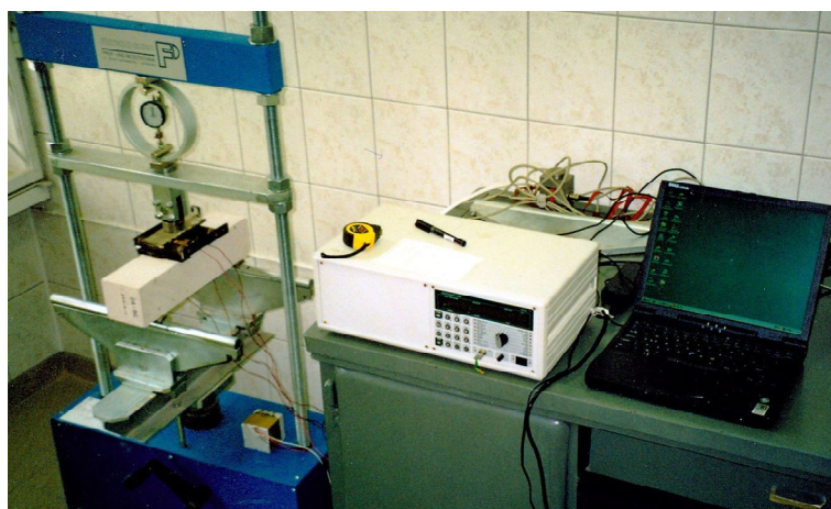
3.5 pav. Dujų silikatbetonio prizmių lenkimo eksperimentas
